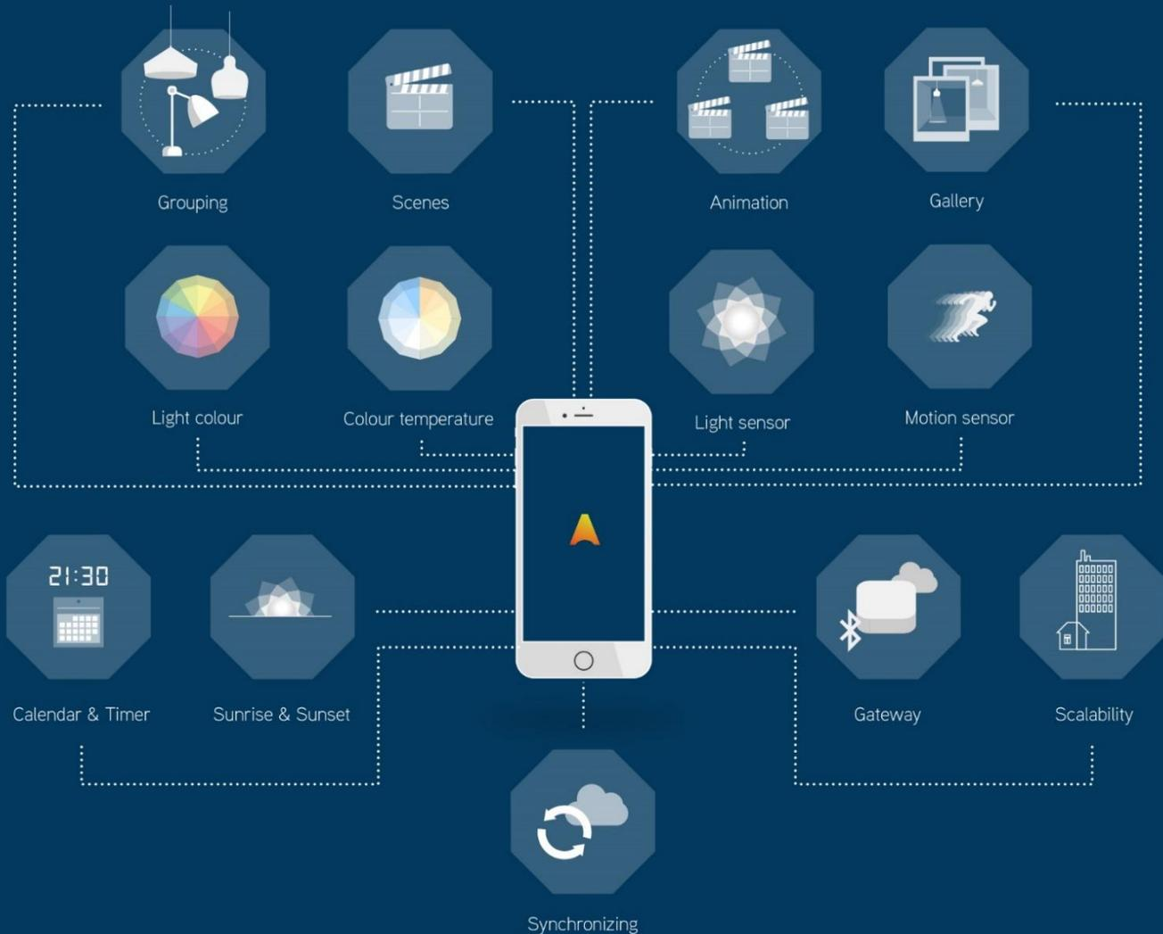
CASAMBI è un sistema avanzato per il controllo dell'illuminazione basato sulla tecnologia Bluetooth Low Energy (BLE). BLE è una tecnologia wireless, a basso consumo di energia, integrata in tutti i moderni smartphone, tablet e smart watch.
