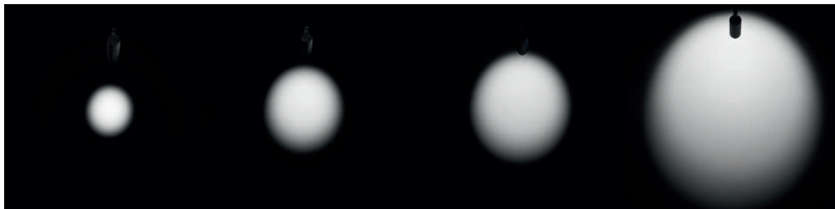
Abstrahlwinkel fokussierbar von 15° bis 90° / Beam angle focusable from 15° to 90°
